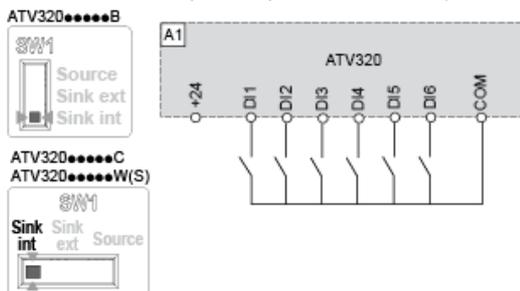
Conmutador SW1 fijado en posición "Sink ext" y uso de una fuente de alimentación externa para las entradas digitales.
