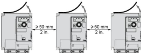
Para funcionamiento a temperatura ambiente por encima de 50 °C (122 °F)
